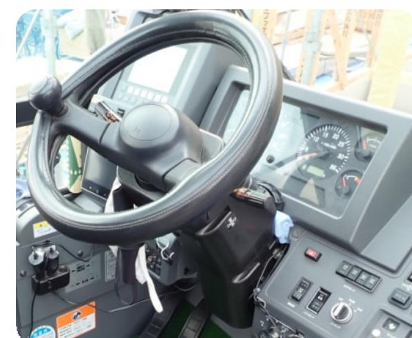
左側面の視界が制限されたためモニター画面(ハンドル左下)で死角をカバーします。
